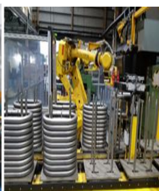
結合機械手臂自動上/下料作業
