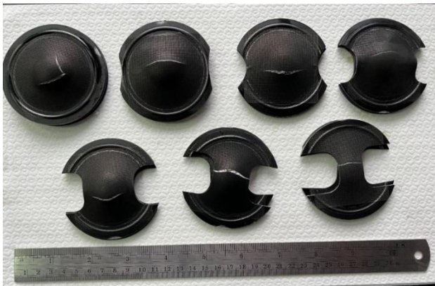
圖 8 混成疊層板材成形極限試片試驗後破裂圖
