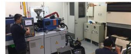
整合碳化矽驅動器於射出機場域節能測試
